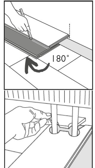
Heizkörper (oder aufsteigende Bauelemente in der Fläche): Addieren Sie zum Durchmesser des aufsteigenden Elements ca. 24mm und schneiden Sie das Element entsprechend zu. Getrennte Elemente kleben Sie ggf. mit D3 Weißeim wieder zusammen.
