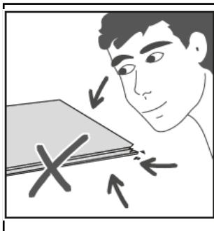
Während der Verlegung die Elemente aus mindestens drei oder mehr Paketen mischen und auf Materialfehler überprüfen. Elemente mit sichtbaren Materialfehlern dürfen nicht verlegt werden.
