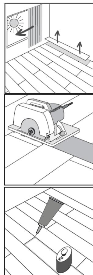
Mithilfe einer Tauchsäge und Schnittschiene wird das Zentrum des beschädigten Elements heraus getrennt. Hierbei seien Sie vorsichtig im Randbereich des Elements, um angrenzende Elemente nicht zu beschädigen. Entfernen Sie nun die restlichen Elementteile aus dem Clickmechanismus.
