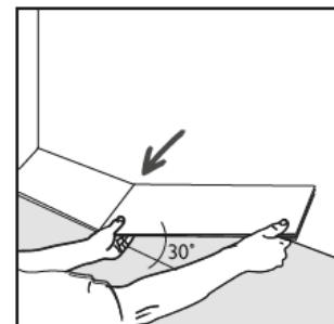
Halten Sie bereits bei der ersten Elementreihe und anschließend zu allen weiteren aufsteigenden Bauelementen (Wände, Säulen, Heizungsrohre etc.) mindestens 10 mm Abstand. Dies kann durch Abstandskeile bewerkstelligt werden. Nichtbeachtung führt zu einem eingespannten Zustand der schwimmenden Konstruktion und führt zu Aufwölbungen im Bodenbelag und in der Folge ggf. zur Zerstörung des Bodenbelags.
